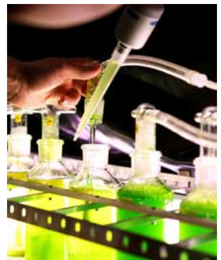
■ Abb. 3: Versuchsreihe zum Einfluss von Kraftwerksabgasen auf das Wachstum von Mikroalgen
